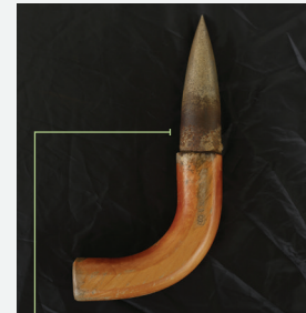
Perforador de mano para facilitar la siembra de las plántulas en las bolsas.
