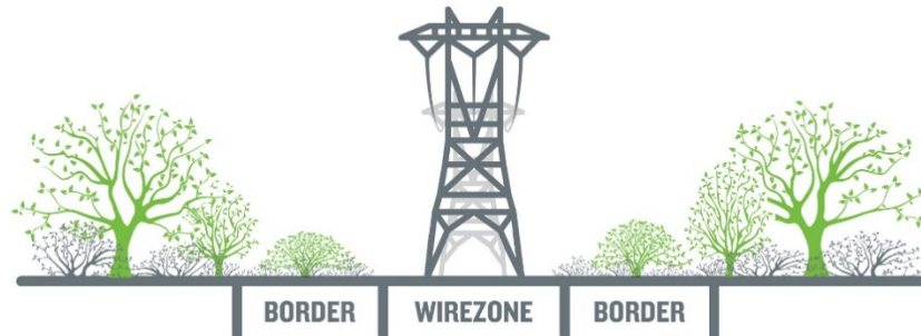
Figura 5. Vegetación y la franja de servidumbre para líneas eléctricas aéreas ( https://www.comed.com/SafetyCommunity/Safety/Pages/Maintenance.aspx )
